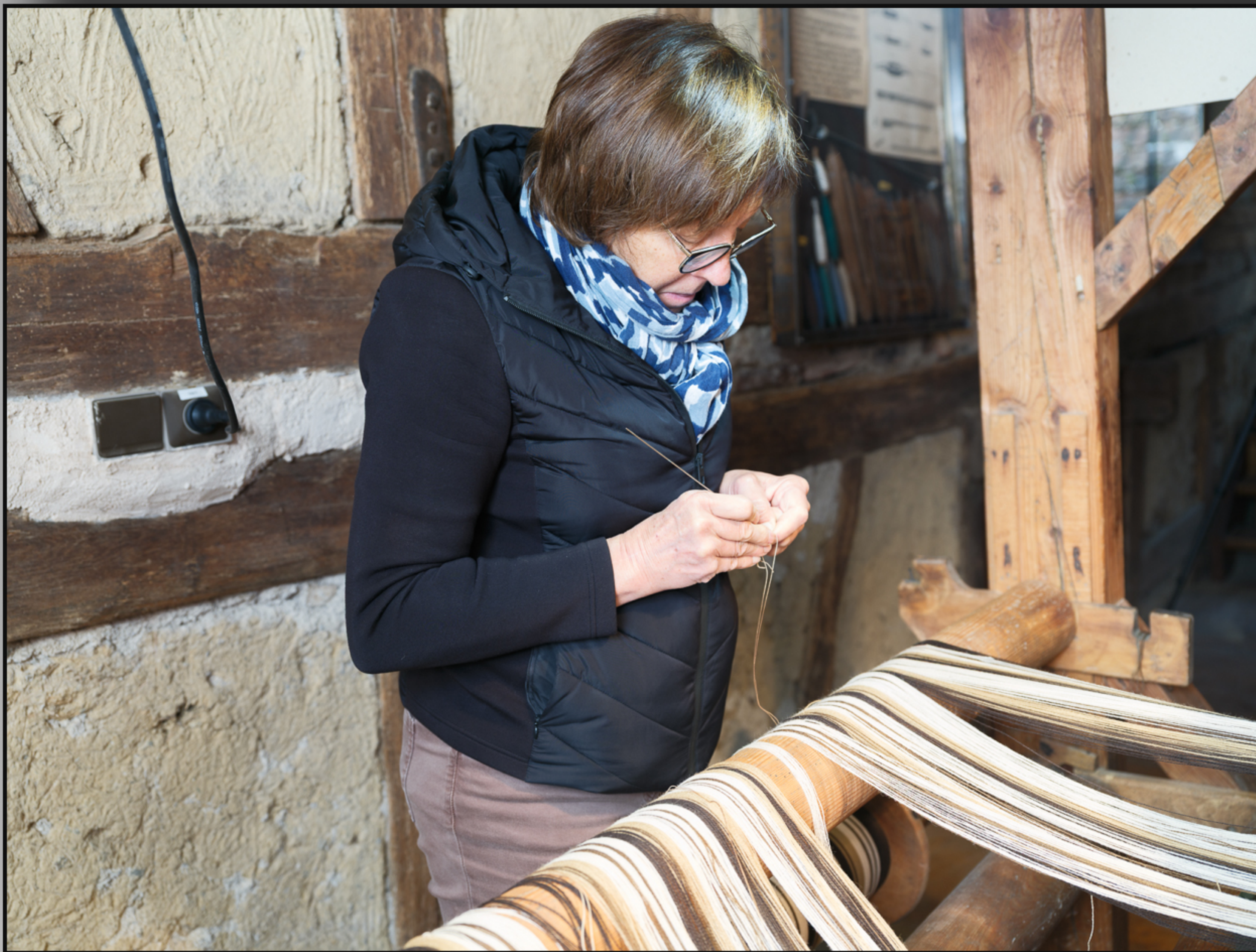
Réfection du métier à tisser, l'enfilage.
