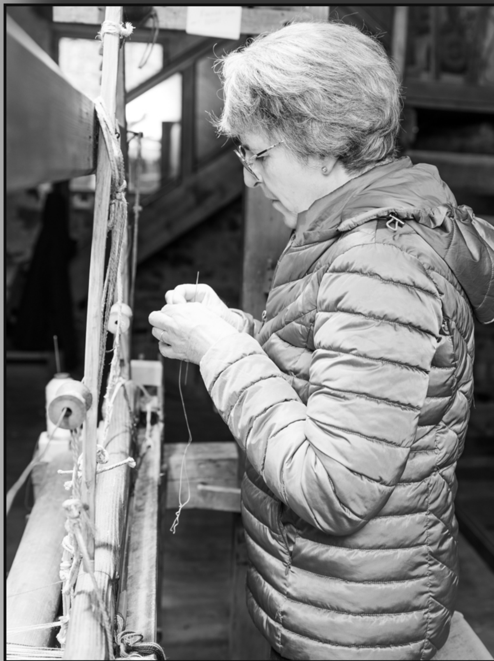
Réfection du métier à tisser, l'enfilage.
