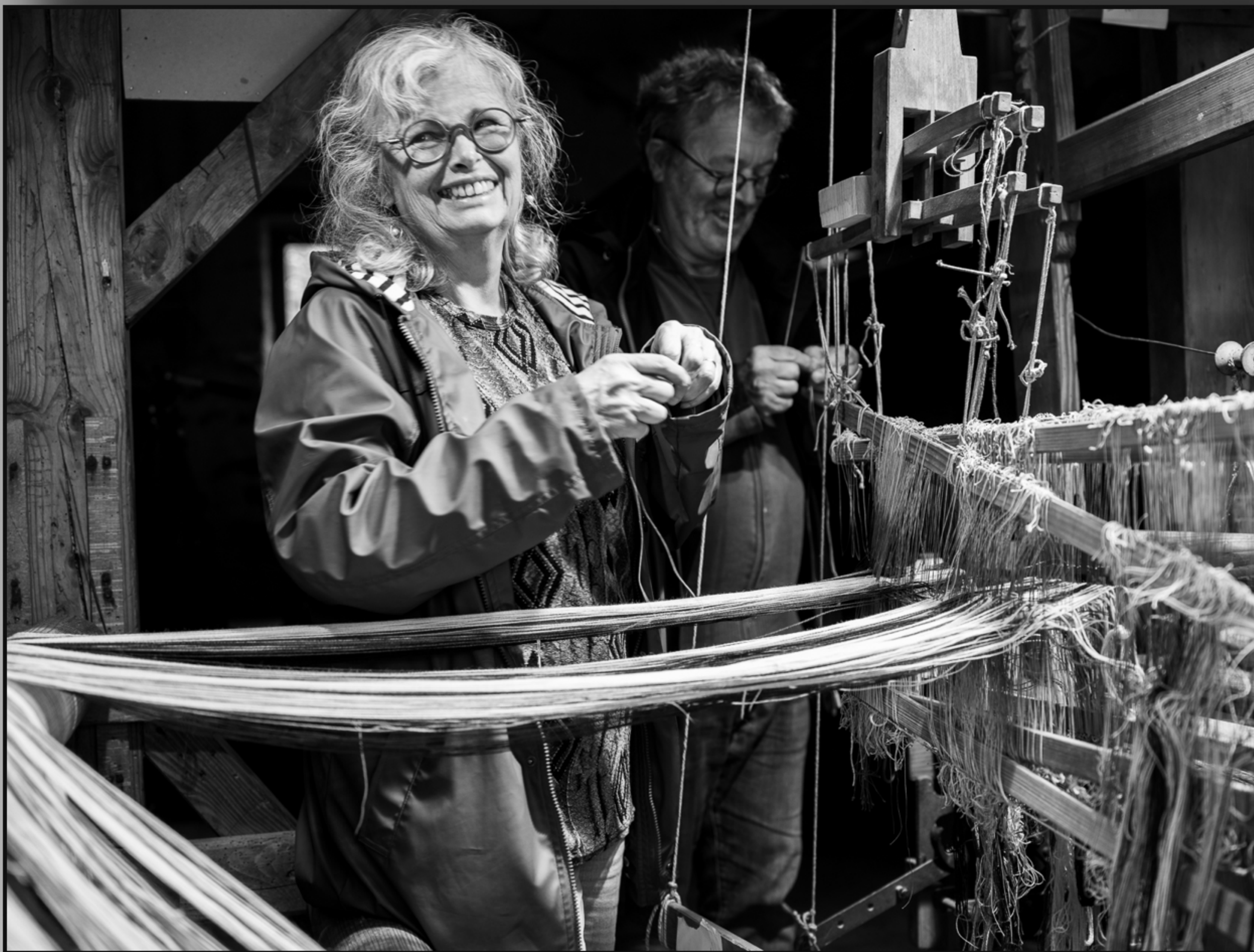
Réfection du métier à tisser, l'enfilage.
