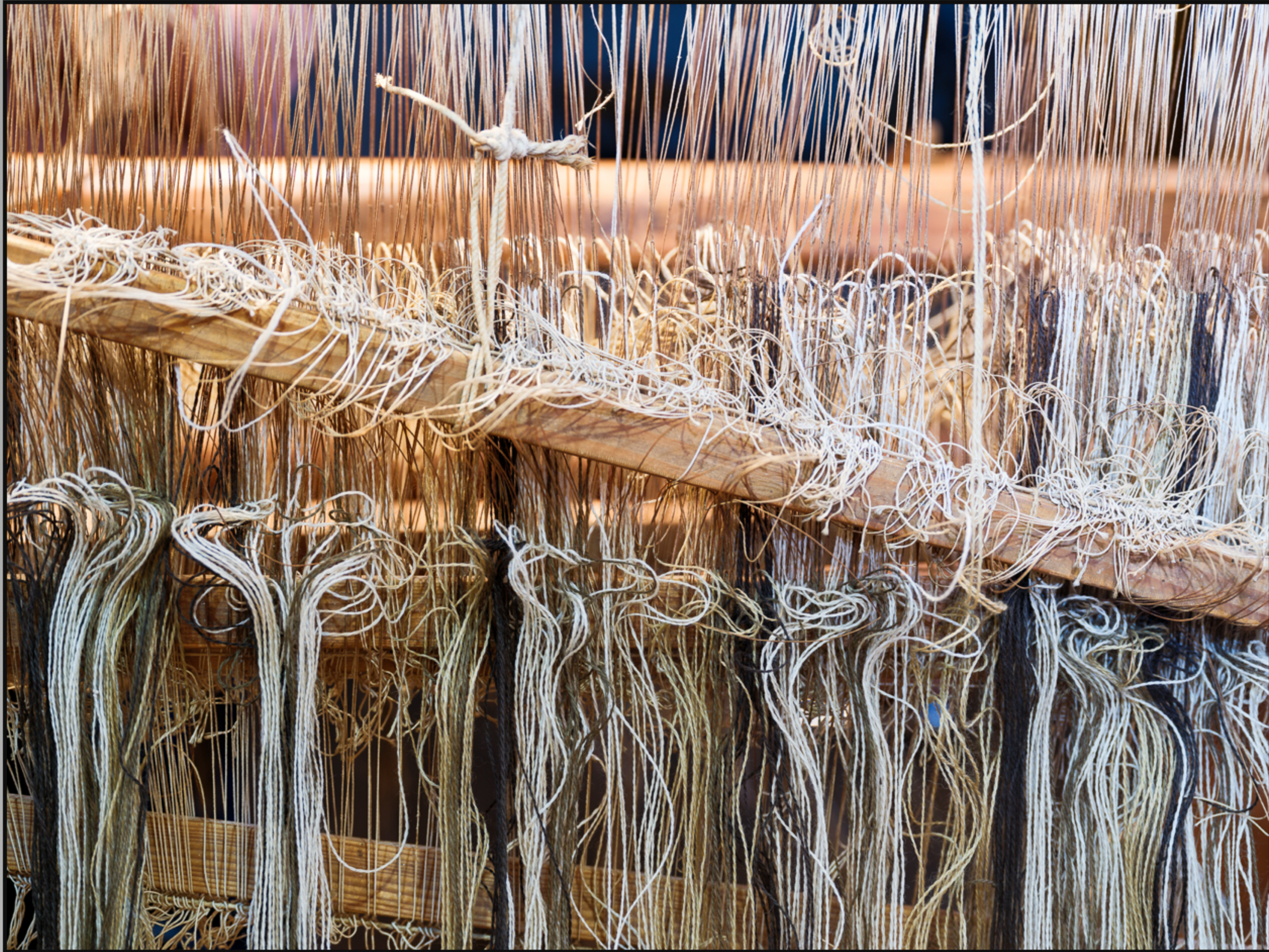
Réfection du métier à tisser, l'enfilage.
