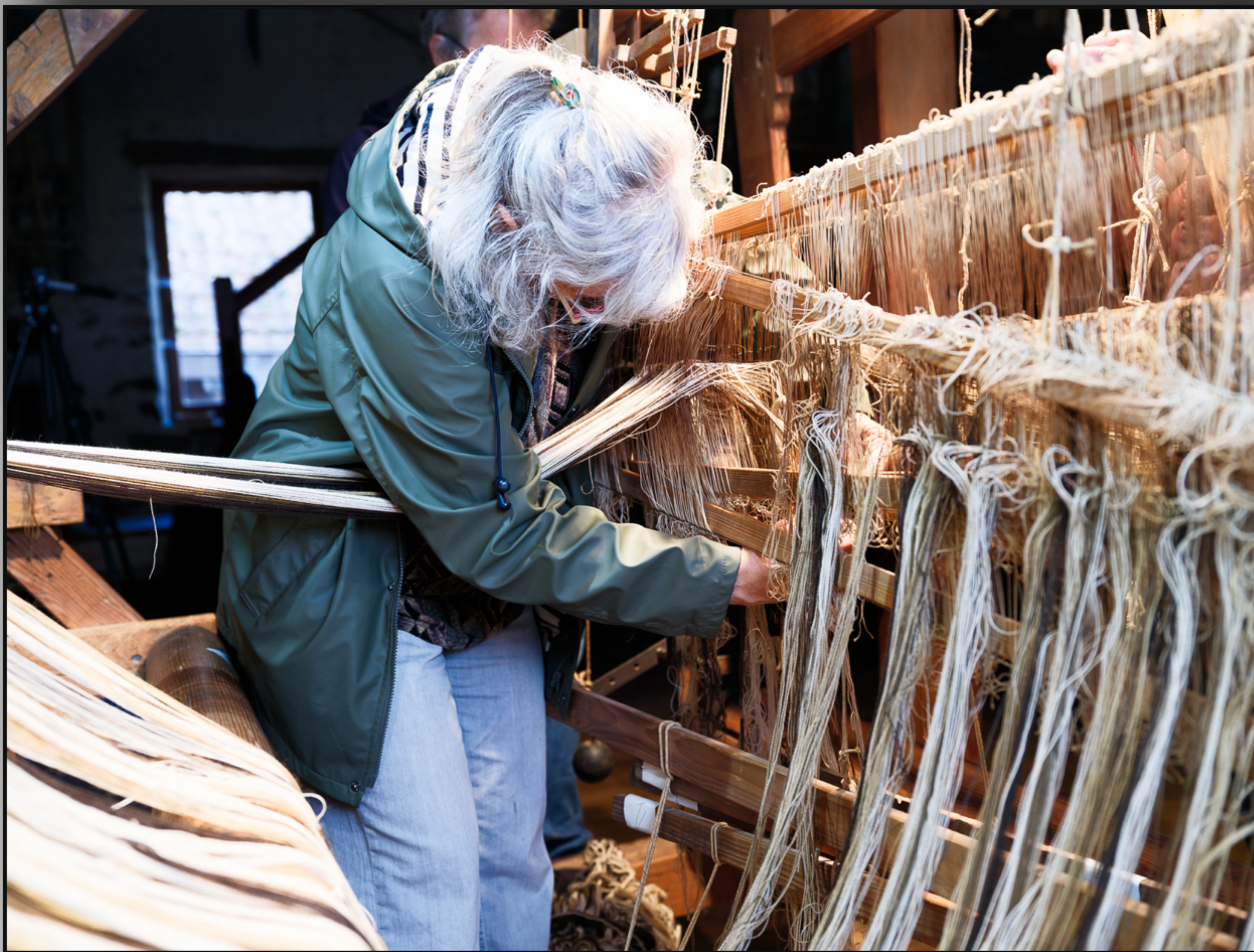
Réfection du métier à tisser, l'enfilage.
