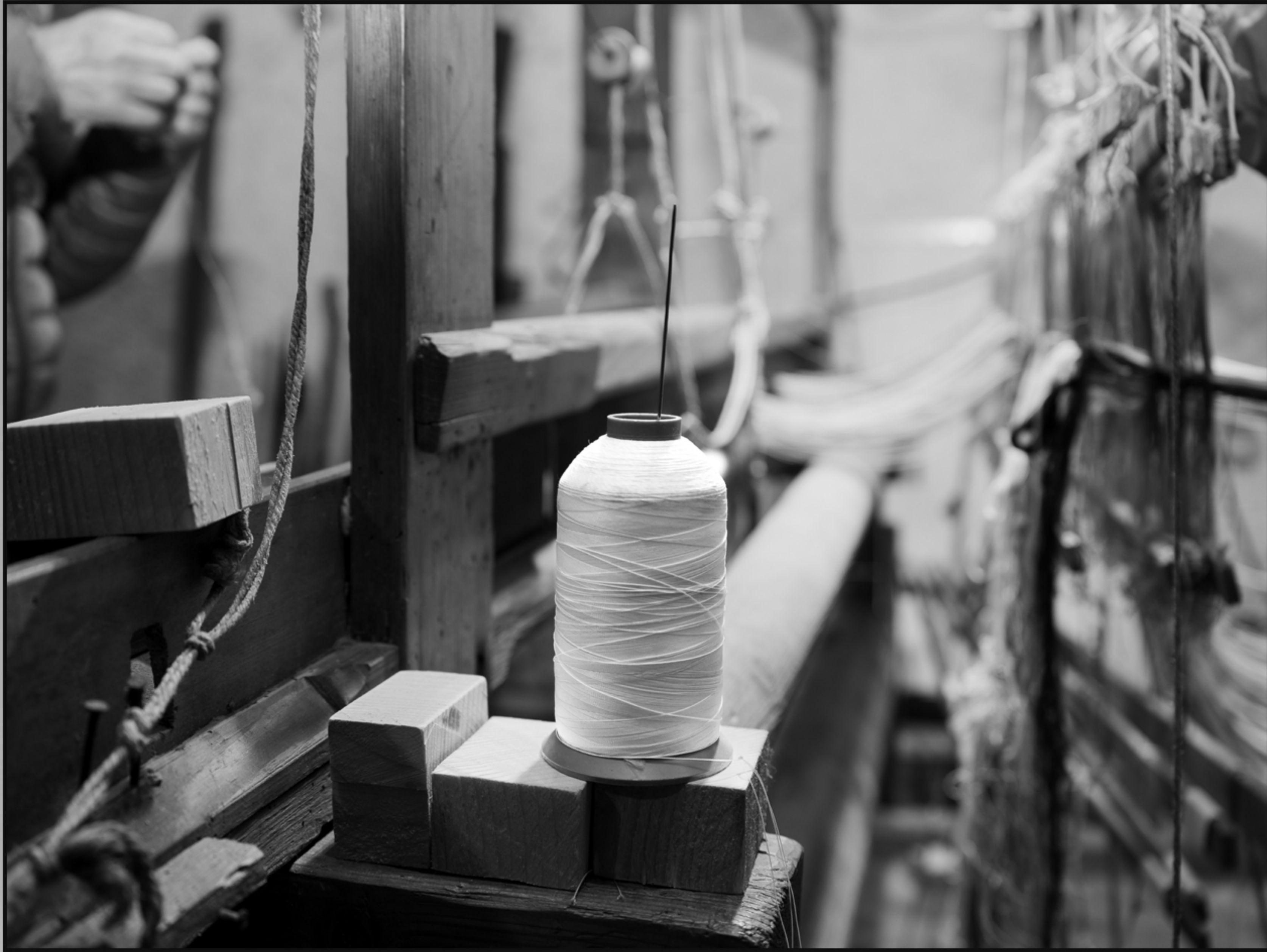
Réfection du métier à tisser, l'enfilage.
