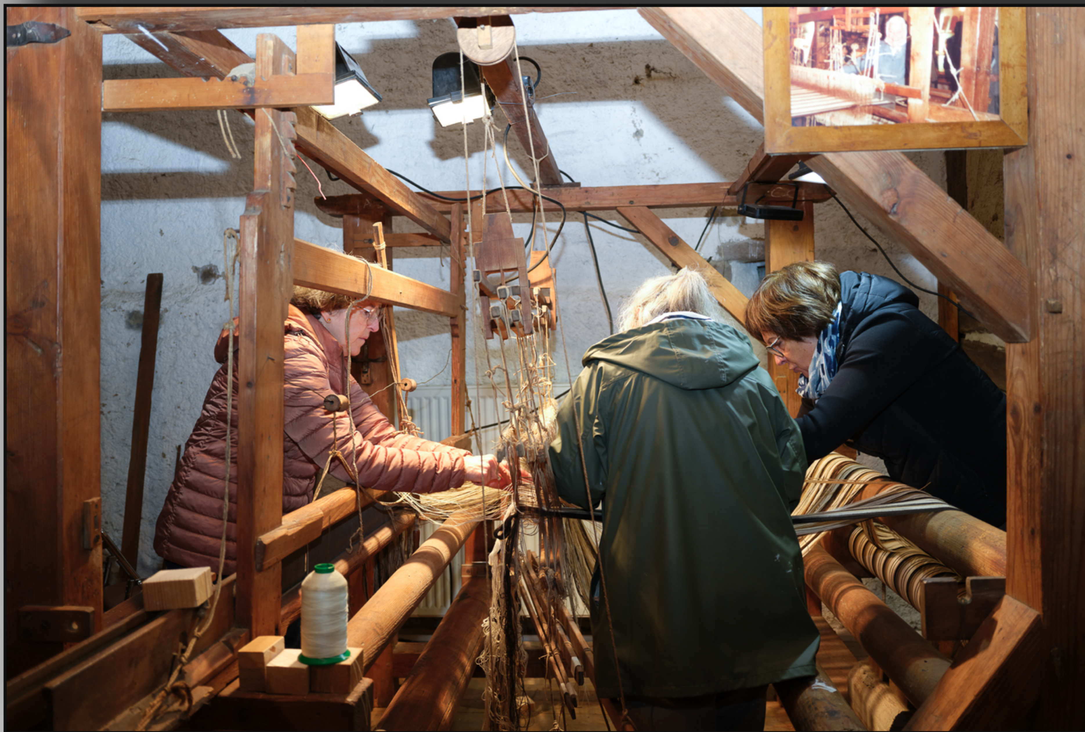
Réfection du métier à tisser, l'enfilage.
