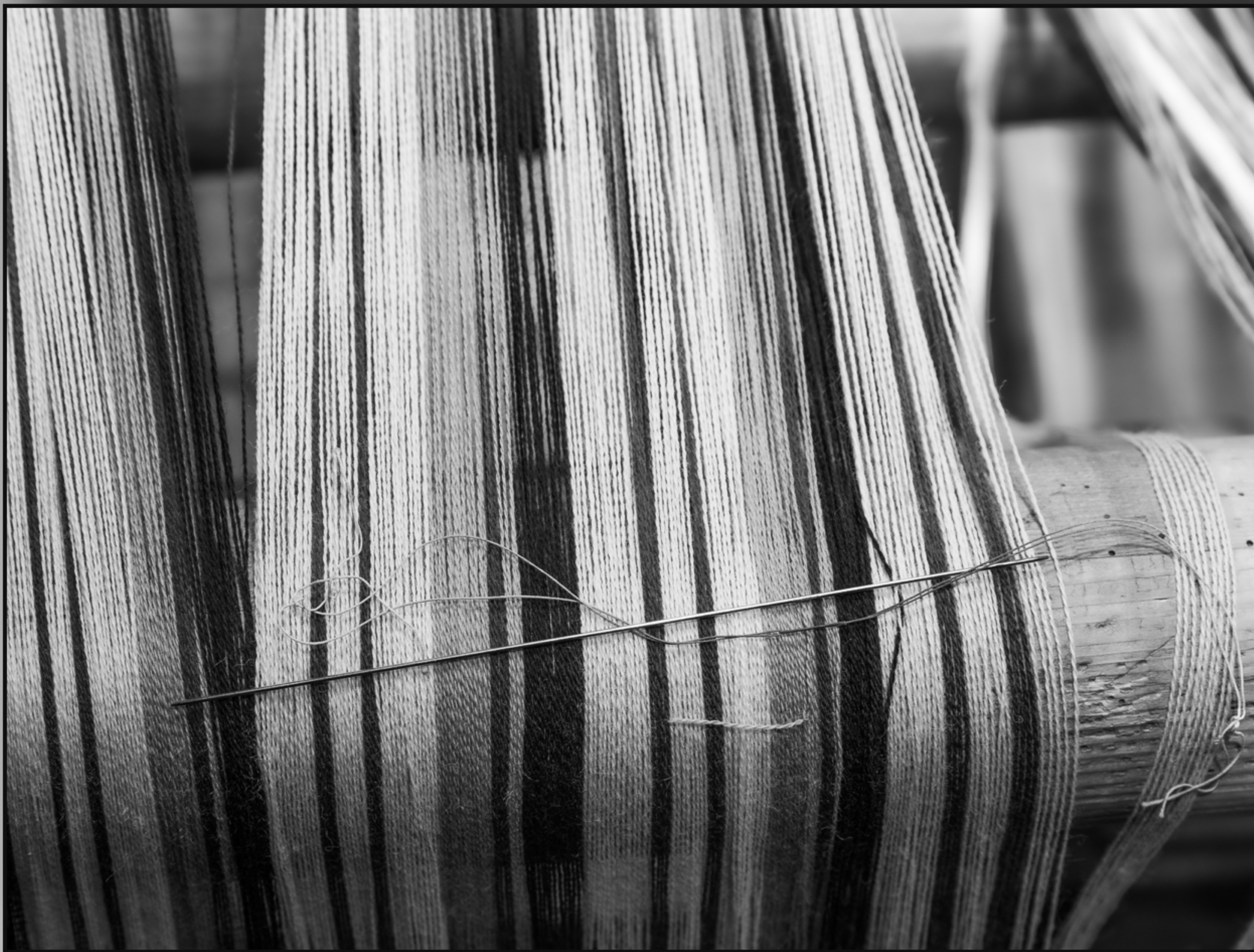
Réfection du métier à tisser, l'enfilage.
