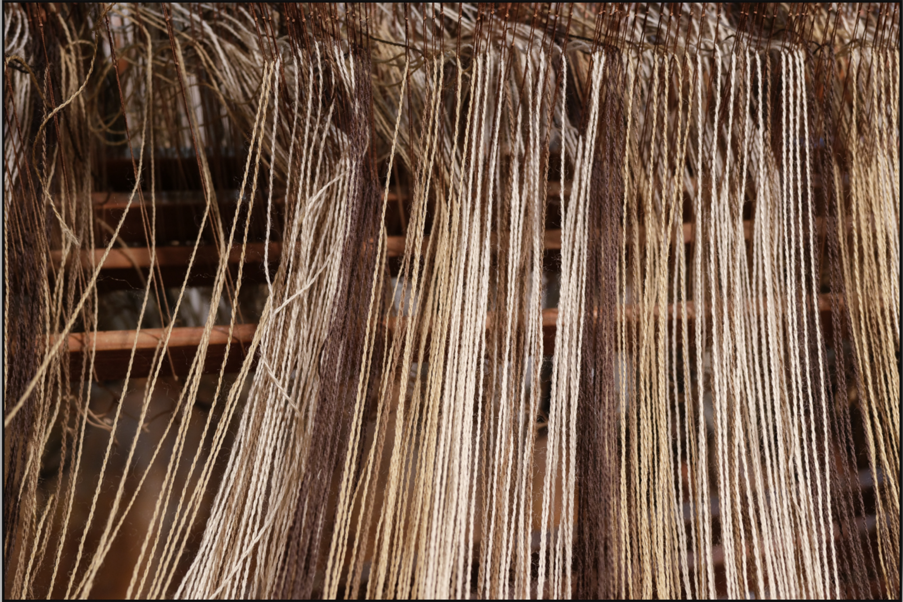
Réfection du métier à tisser, l'enfilage.
