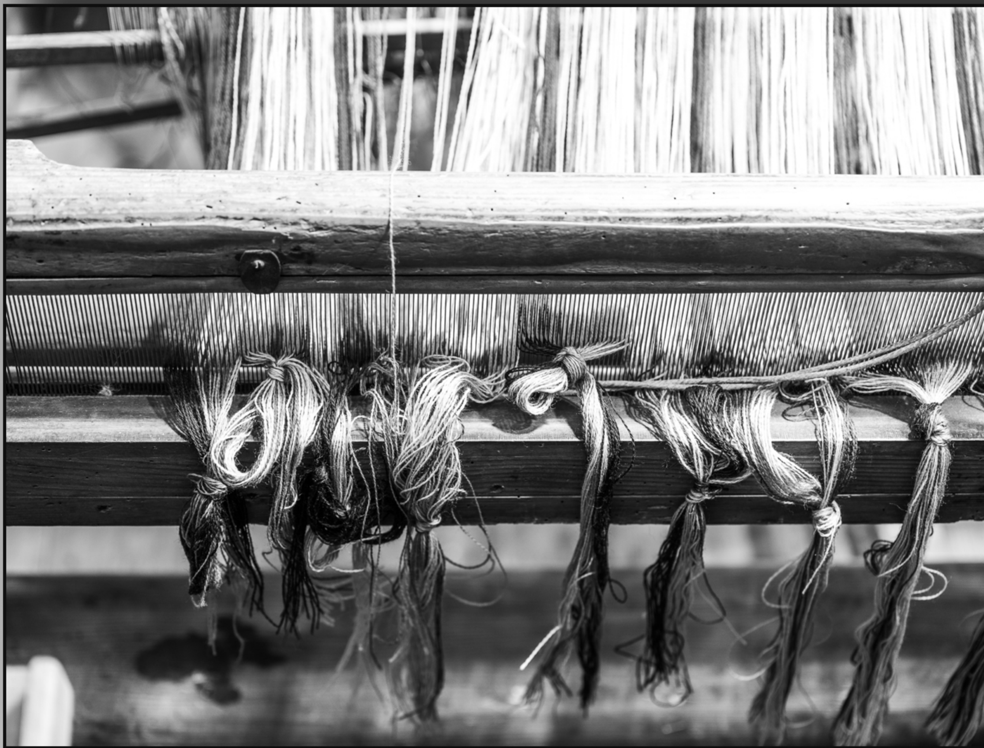
Réfection du métier à tisser, l'enfilage.
