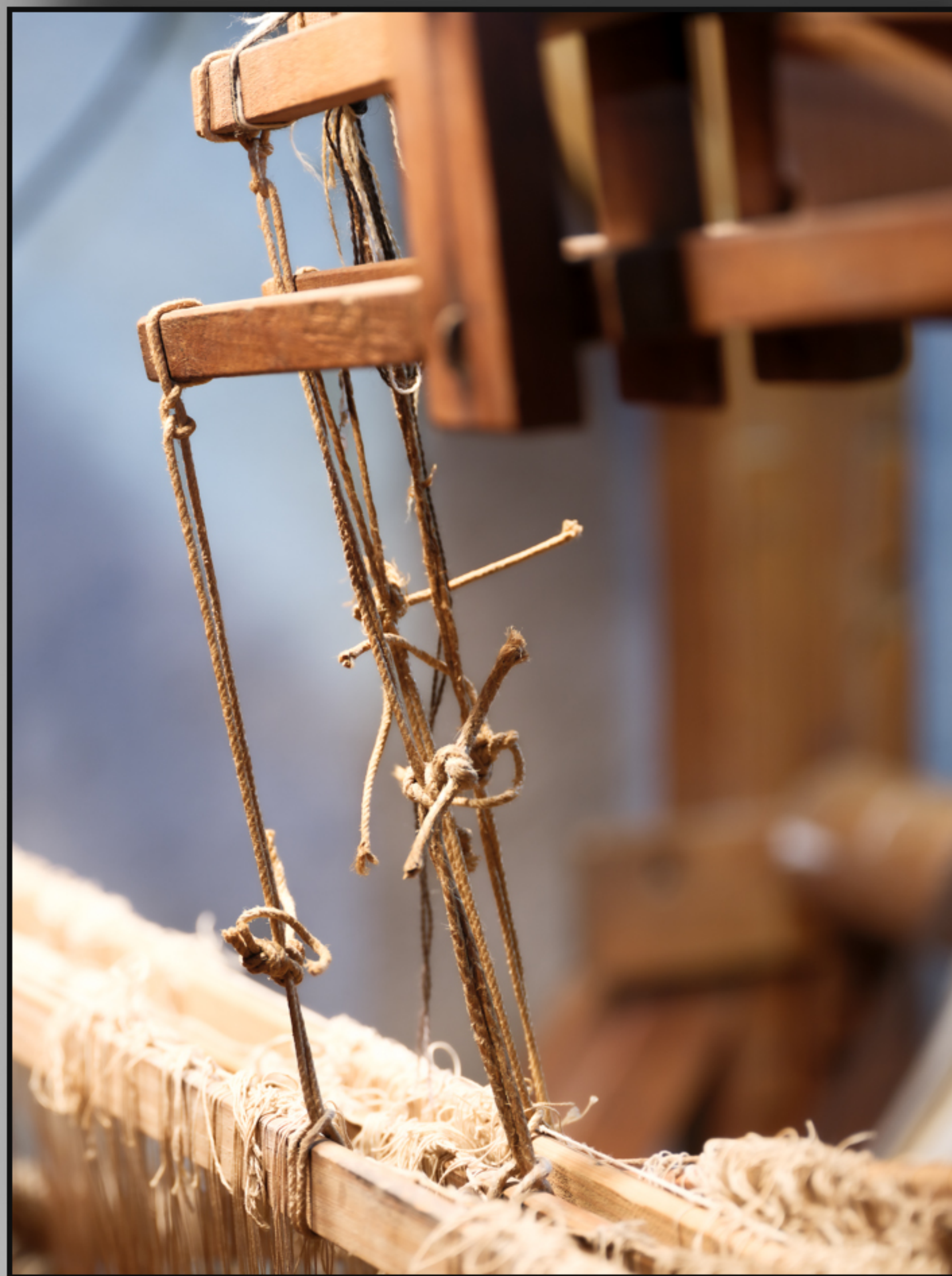
Réfection du métier à tisser, l'enfilage.
