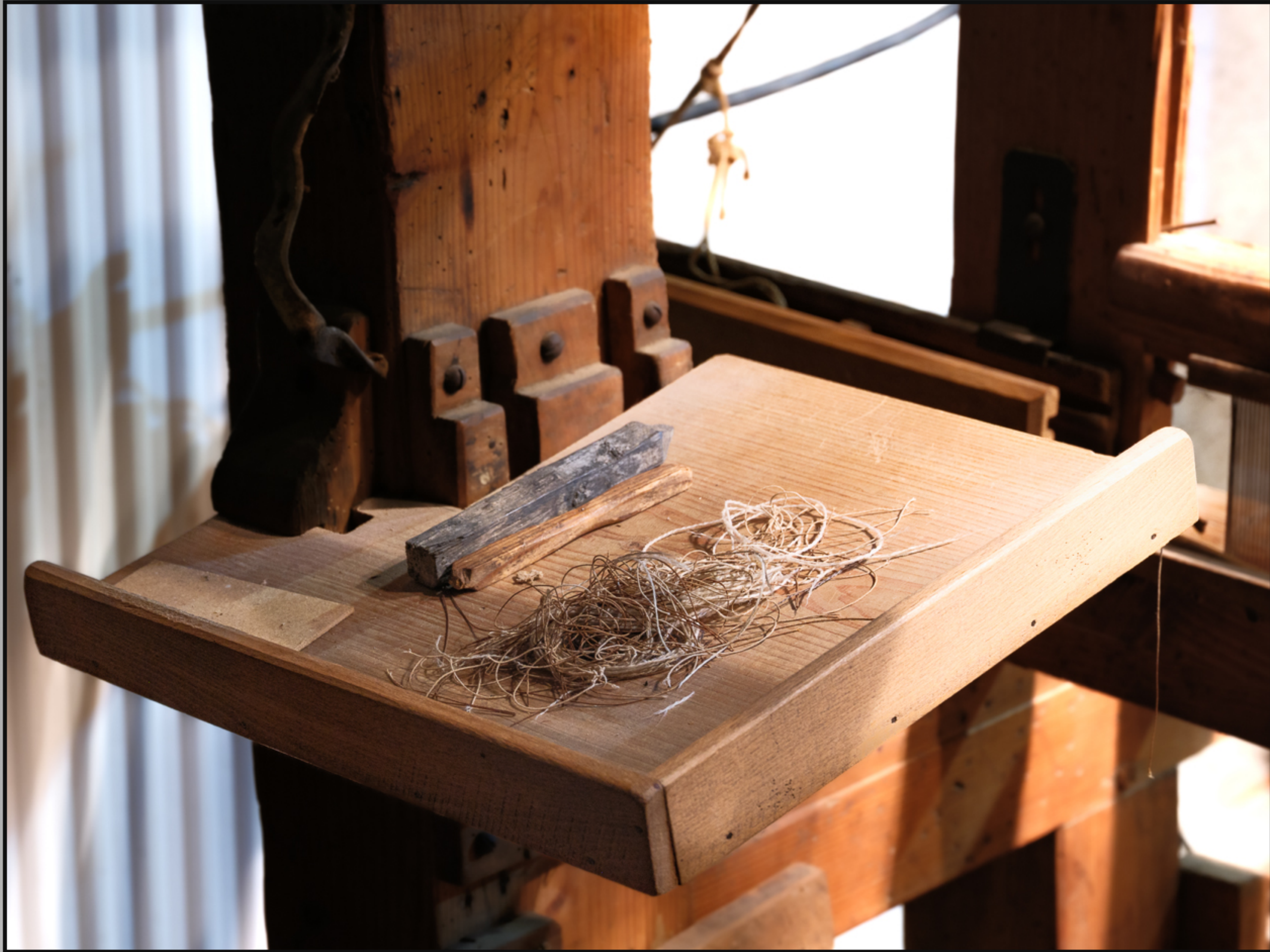
Réfection du métier à tisser, l'enfilage.
