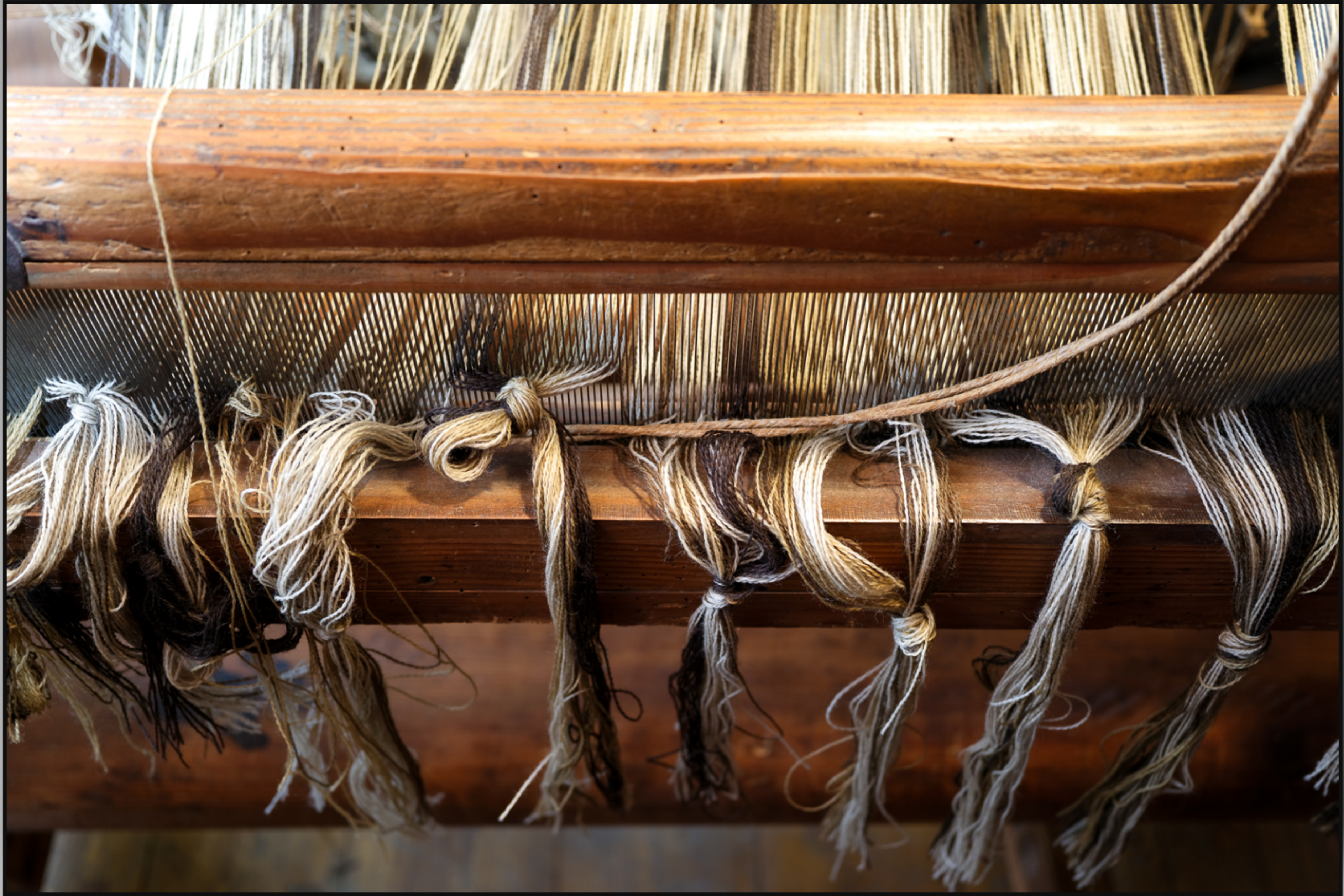
Réfection du métier à tisser, l'enfilage.
