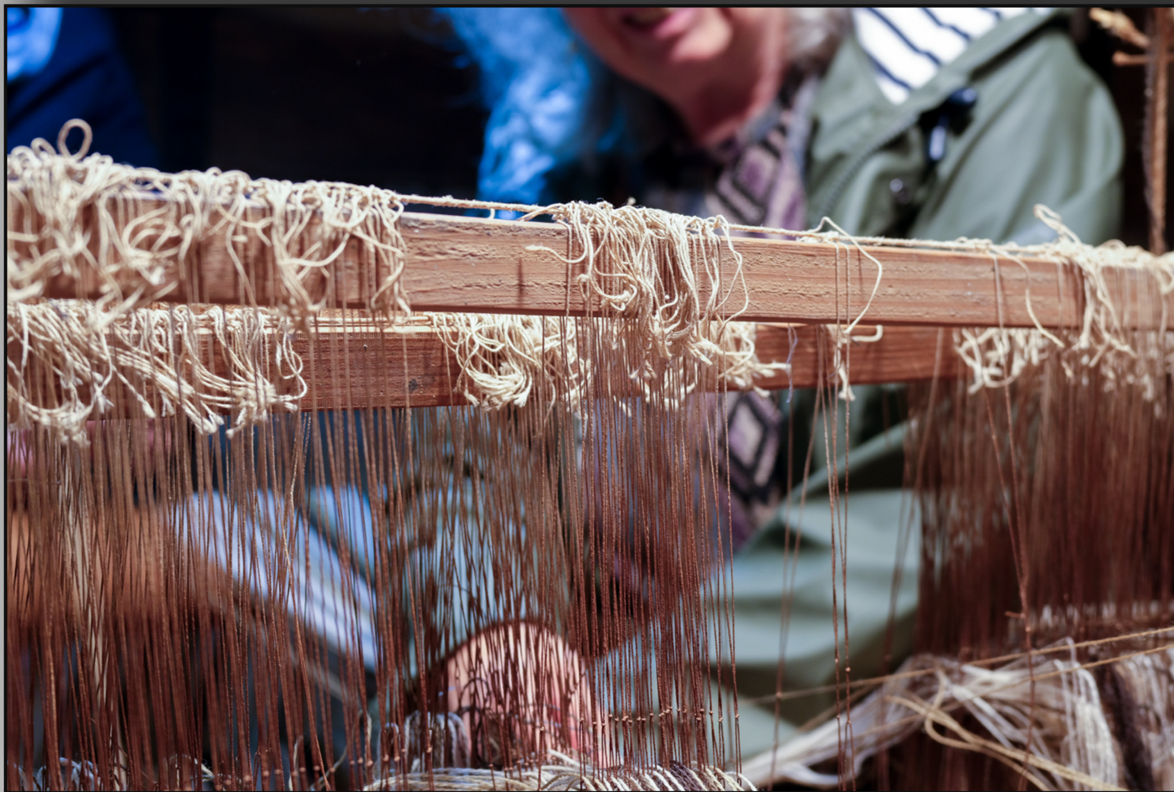
Réfection du métier à tisser, l'enfilage.
