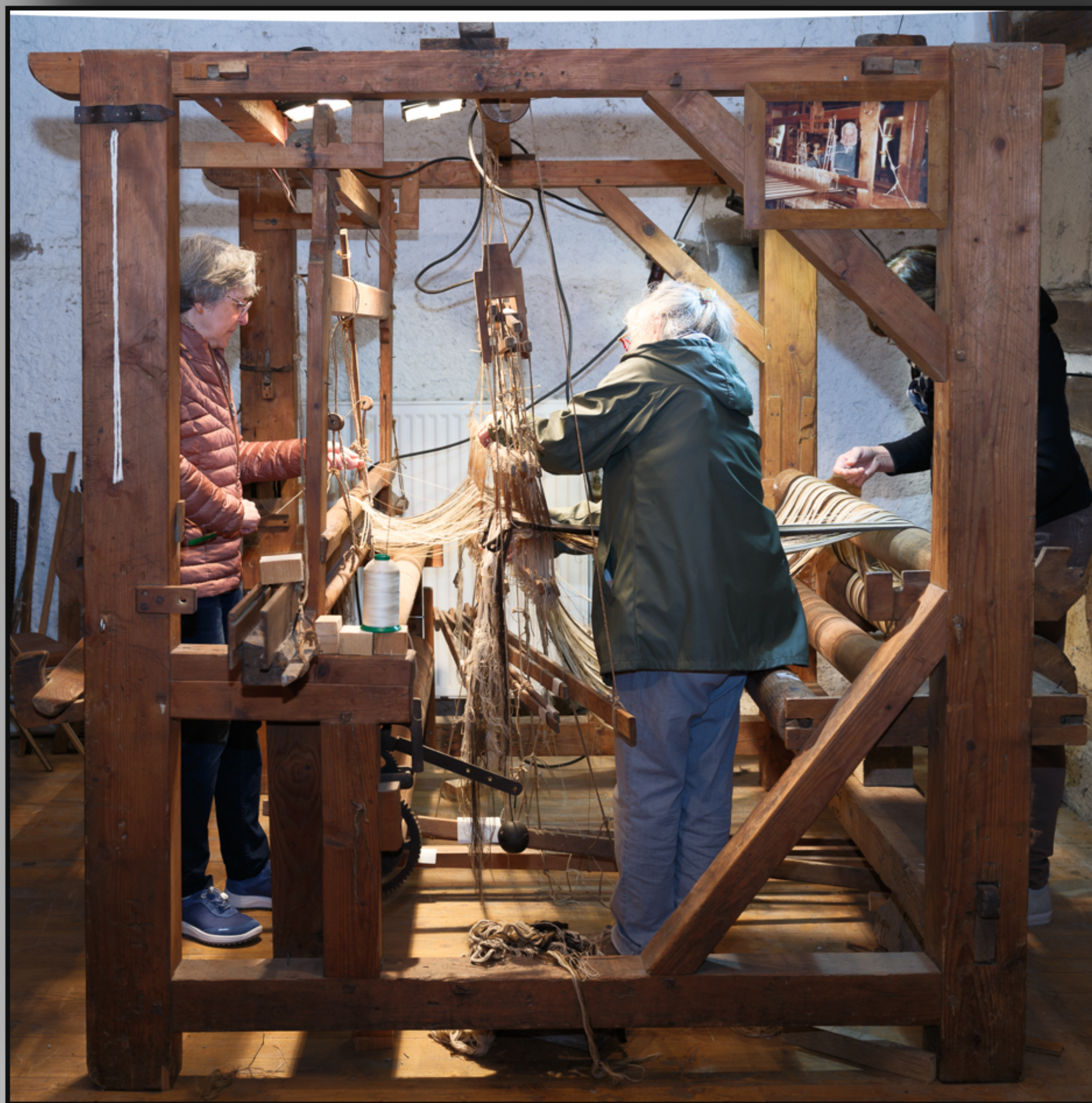
Réfection du métier à tisser, l'enfilage.
