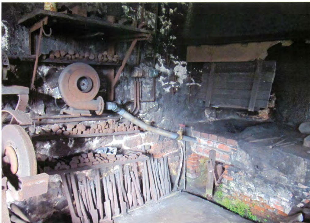
Le petit foyer et la soufflerie qui a remplacé le soufflet (AD)
