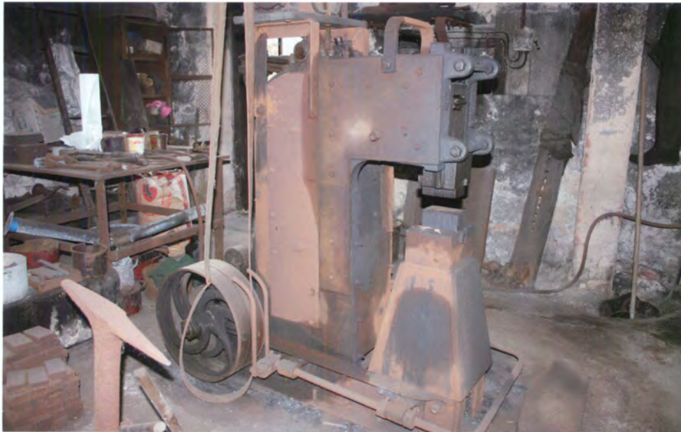
Le marteau-pilon qui a remplacé le martinet (BH)
